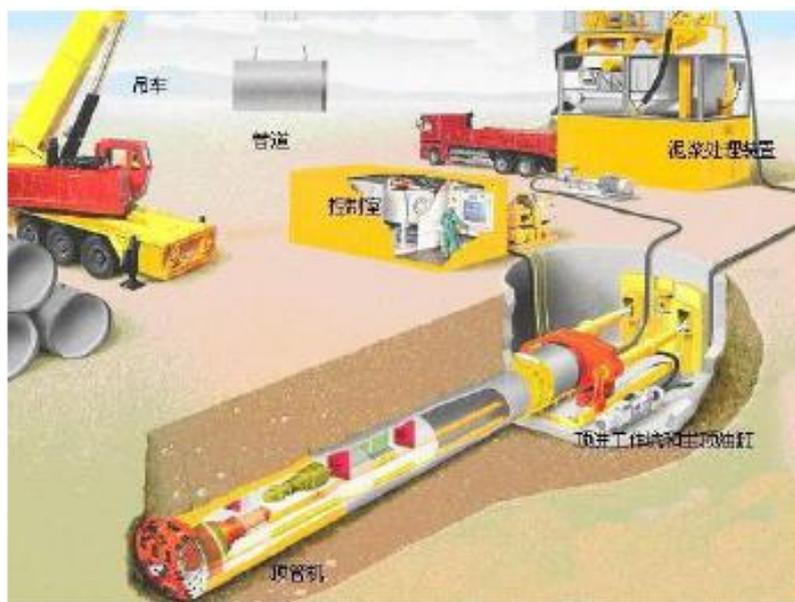
图 3.14-9 顶管施工工艺简图及立面图
