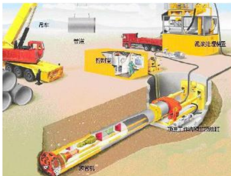
图 3.13-12 顶管施工工艺简图及立面图
